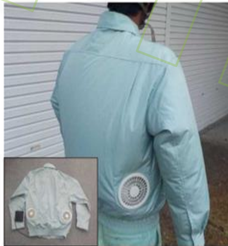
▲空調服を作業員に配布
